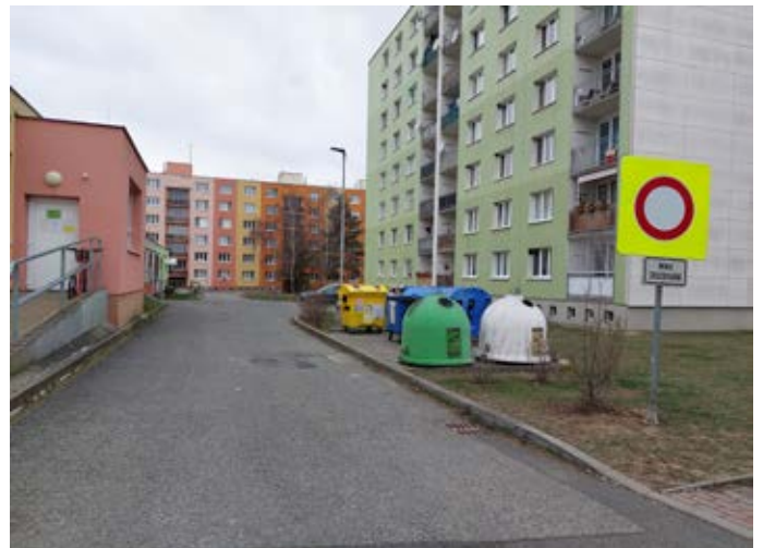
Fotografie byla pořízena jen pár minut po osazení zvýraznění retroreflexním žlutým okrajem svislé dopravní značky B1 u školní jídelny.
